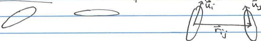
$$V_{ij} = 4\epsilon(r_{ij}, \hat{u}_i, \hat{u}_j) \left[ \left( \frac{\sigma_0}{r_{ij} - \sigma(r_{ij}, \hat{u}_i, \hat{u}_j) - \sigma_0} \right)^{12} - \left( \frac{\sigma_0}{r_{ij} - \sigma(r_{ij}, \hat{u}_i, \hat{u}_j) - \sigma_0} \right)^6 \right]$$
